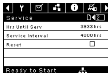
Illustration 42 : Configuration De La Maintenance
