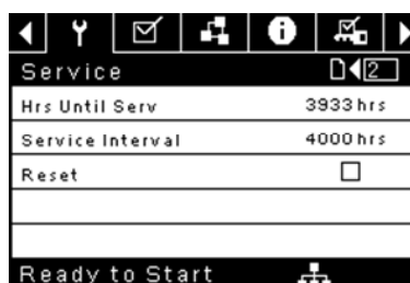
Figura 42 : Configuração da manutenção
