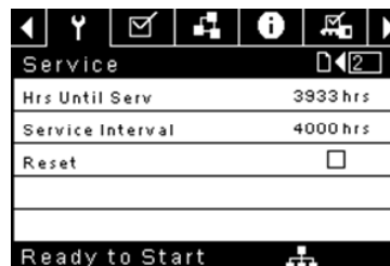
Figura 19 : Configuración De Mantenimiento
