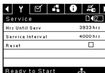
Figura 19 : Configuração da manutenção
